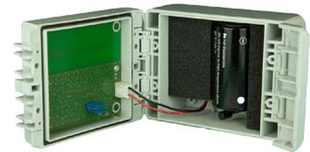
L'électronique est logée dans un boîtier en polycarbonate. Il est conforme à la norme IP67 et possède une résistance aux chocs IK7. Le boîtier est monté à l'aide de 4 vis. Ceux-ci sont montés dans les coins du boîtier et ne sont pas accessibles lorsque le boîtier est fermé. La balise électronique est fixée dans le couvercle. Le couvercle peut être complètement séparé du boîtier (serrure à clic). Si nécessaire, le boîtier fermé peut être vissé avec 4 vis de sécurité supplémentaires.
